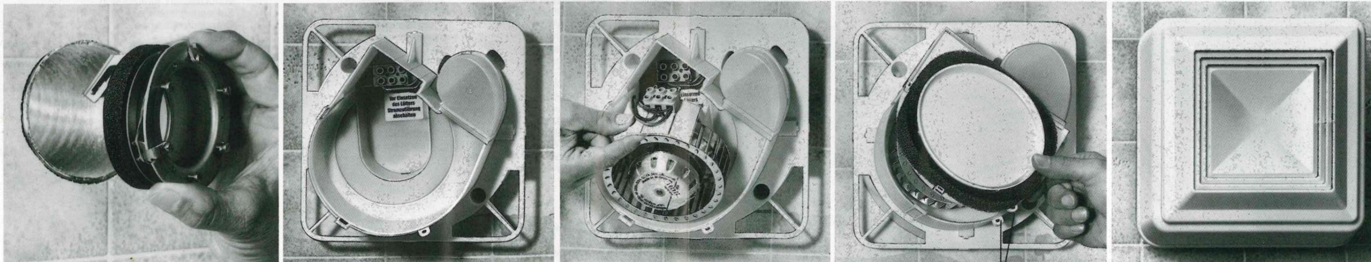
**1.** Die Klappen-Baugruppe in das putzbündig abgeschnittene Rohr (75 oder 80 mm Ø) mit Pfeil nach oben einsetzen und Spreizkrallen anziehen. (Der Abstand von Mitte Rohr zur Wand bzw. Decke muß mindestens 75 mm betragen.)
